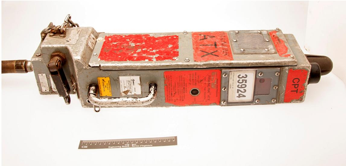
Figure 1: Unité de détection et de freinage (UDF) de Wabtec Railway Electronics telle que reçue.
