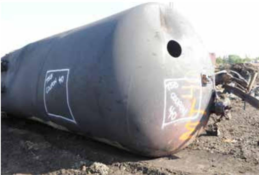
Figure 7: Photographie des coupons marqués sur la tête et la coque du wagon-citerne CTCX 735572
