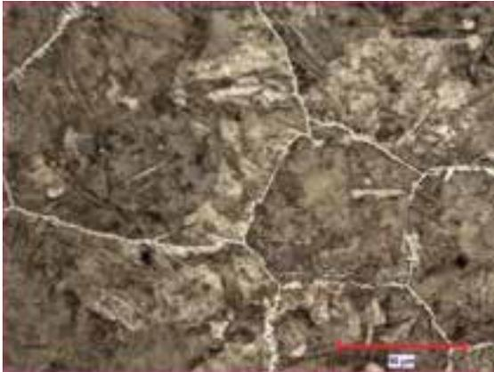
(b) Micrographie optique prise à proximité de la surface intérieure (attaque au nital, grossissement initial de  $\times 200$ )
