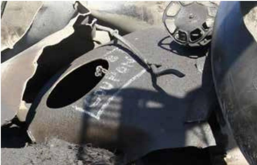
(a) Tête prélevée sur la citerne, avec trou rond à l'endroit où le coupon a été découpé au moyen d'un équipement de coupe au jet d'eau
