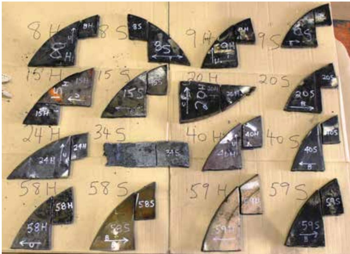
Figure 11: Photographie des échantillons découpés dans chaque coupon
