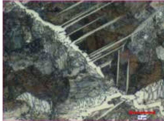
(c) Micrographie optique prise à proximité de la surface intérieure (attaque au nital, grossissement initial de  $\times 1000$ )
